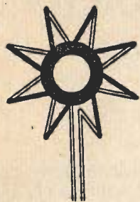
Рис. 10. Схема приемной части термоэлектрического актинометра (термозвездочка)
